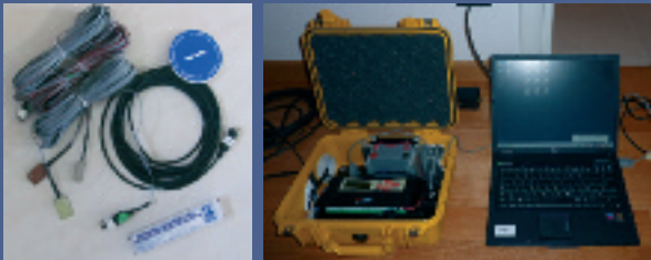
In alto, termografia preliminare per individuare la zona più idonea alla posa del termoflussimetro; sopra a sinistra, piastra termoflussimetrica per la misurazione del flusso di calore e sensori di temperatura (termocoppia) per il rilievo della temperatura superficiale interna della parete. A destra, kit strumentazione per misura termoflussimetrica (Fonte: ing. A. Panzeri, ANIT).
